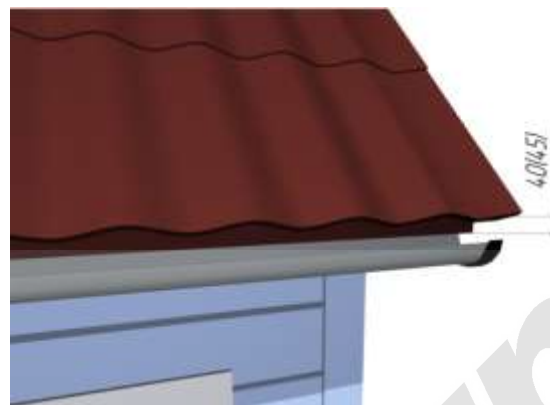
Рис.6 Укладка металлочерепицы на карнизную планку
